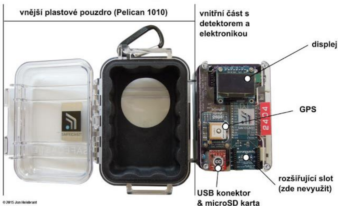
Obr. 16 Kit mimo pouzdro, pouzdro samotné má vyřízný otvor v gumové vystýlce k snížení stínění. [online]. [cit. 2020-03-23]. Dostupné z: https://www.suro.cz/cz/faq/detektor-safecast-bgeigie-nano-technicke-parametry
