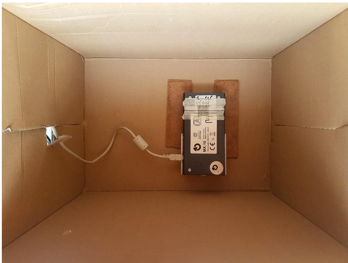
Obr. 3 Částicová kamera položená v krabici připravená na měření. Vlastní obrázek.
