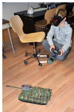
FPV model tanku a jeho řízení přes brýle
